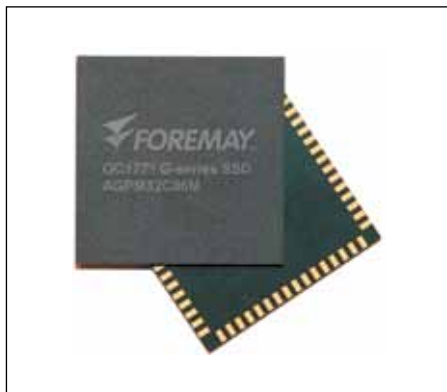
Рис. 7. Внешний вид накопителя SATA DOC из серии OC177
