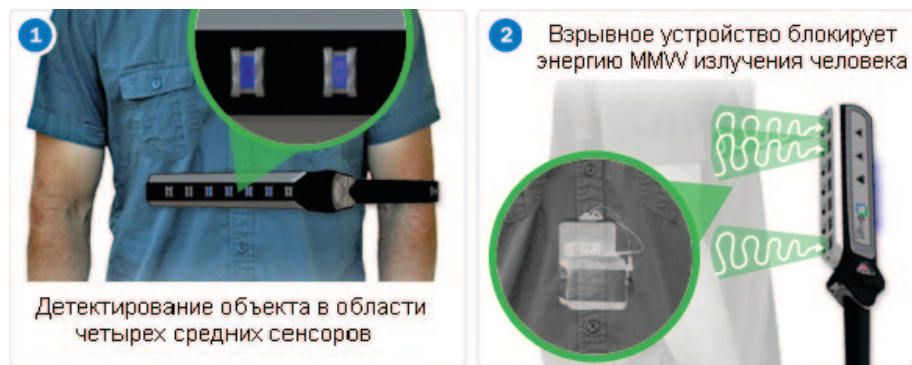
Рис. 2. Обнаружение скрытых предметов при помощи ручного сканера AllClear
