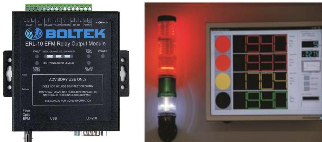
Рис. 6 – Внешний вид и демонстрация работы вспомогательного модуля ERL-10.
