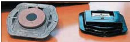
Рис. 9. Внешний вид беспроводного передатчика энергии DM TX-19V15W-EZ-SYS
